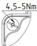
Una vez efectuada la conexión eléctrica, la tapa de la caja de conexiones debe atornillarse con un par de apriete de 4,5-5Nm.
